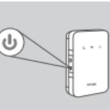
6. Pulse y mantenga presionado el botón de alimentación durante cuatro segundos para encender el dispositivo. Una vez que el icono LED de alimentación se encienda en verde fijo, podrá pasar a la configuración.
