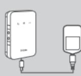
5. Dugja az USB-kábel micro USB végét az DWR-932 alján található micro USB portba, majd dugja az USB végét a tápadapter vagy számítógép USB-portjába az akkumulátor töltéséhez. Miután a feltöltés véget ért, használhatja ezt az USB-portot a mobilkészülékei töltésére.
