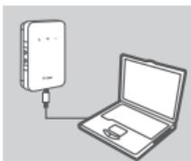
1. Priključite DWR-932 v vaš računalnik s pomočjo kabla USB. Sledite pojavnim oknom gonilnika Windows na zaslonu.
