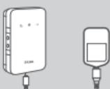
5. Connectez l'extrémité micro-USB du câble USB au port micro-USB situé en bas du DWR-932, puis branchez l'extrémité USB dans le port USB de l'adaptateur secteur ou de l'ordinateur pour faire charger la batterie. Une fois la recharge terminée, vous pouvez utiliser ce port USB pour alimenter vos périphériques mobiles.
