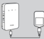
5. Schließen Sie den Micro-USB Stecker des USB-Kabels an die Micro-USB Buchse unten am DWR-932 an und stecken Sie das USB-Ende in den USB-Port des Netzteils oder in einen PC, um den Akku aufzuladen. Nach dem Aufladen können Sie über diesen Port Ihre Mobilgeräte mit Strom versorgen.
