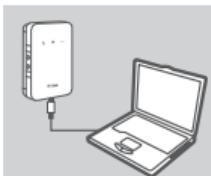
1. Tilslut DWR-932 til din PC med USB-kablet. Følg skærmens Windows-driver pop ops.
