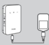
5. Podłącz wtyczkę mikro USB kabla USB do portu mikro USB u dołu routera DWR-932; podłącz wtyczkę USB do portu USB zasilacza lub komputera, aby naładować baterię. Po naładowaniu routera można użyć tego portu USB do zasilania urządzeń mobilnych.
