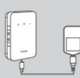
5. Priklučite Micro USB kraj USB kabela u Micro USB priključak na dnu uređaja DWR-932 i priključite USB kraj kabela u USB priključak na adapteru napajanja ili na računalu kako biste napunili bateriju. Nakon što punjenje bude završeno, možete upotrijebiti taj USB priključak za punjenje svojih mobilnih uređaja.
