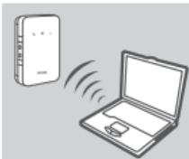
1. Pomocí bezdrátového adaptéru počítače se připojte k bezdrátové sítě **dlink\_DWR-932\_xxxx**. Název bezdrátové sítě (SSID) a heslo jsou vytisknuty na štítku pod baterií.
