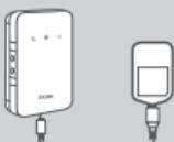
5. Conecte el extremo Micro USB del cable USB al puerto Micro USB de la parte inferior del DWR-932 y enchufe el extremo USB en el puerto USB del adaptador de alimentación o de un PC para cargar la batería. Una vez finalizada la carga, puede usar este puerto USB para alimentar sus dispositivos móviles.
