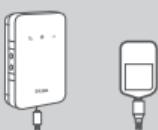
5. Koble Micro USB-enden av USB-kableten til Micro USB-porten nederst på DWR-932 og sett USB-enden inn i USB-porten på strømadapteren eller en PC for å lade batteriet. Når oppladingen er fullført, kan du bruke denne USB-porten til å drive mobilenhetene dine.
