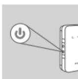
6. Πατήστε παραπεταμένα το κουμπί λειτουργίας για τέσσερα δευτερόλεπτα, για να ενεργοποιήσετε τη συσκευή. Μόλις το εικονίδιο ένδειξης λειτουργίας LED γίνει σταθερά πράσινο, μπορείτε να προχωρήσετε στη ρύθμιση παραμέτρων.
