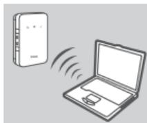
1. Gebruik de draadloze adapter van uw pc om een verbinding te maken met het draadloze netwerk **dlink\_DWR-932\_xxxx**. De naam van het draadloze netwerk (SSID) en het wachtwoord staan op het etiket onder de batterij.
