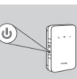
6. Stisknutím a podržením tlačítka napájení po dobu čtyř sekund zařízení zapnete. Jakmile LED kontrolka napájení začne svítit zeleně, můžete pokračovat v konfiguraci.
