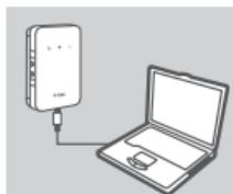
1. Priključite DWR-932 na računalo pomoću USB kabela. Slijedite upute na iskačućim okvirima na zaslonu za instalaciju upravljačkog programa za Windows.
