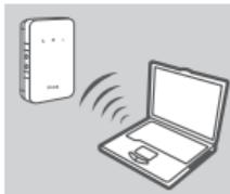
1. Utilisez l'adaptateur sans fil de votre PC pour vous connecter au réseau sans fil **dlink\_DWR-932\_xxxx**. Le nom de ce réseau sans fil (SSID) et le mot de passe sont imprimés sur l'étiquette, en dessous de la batterie.
