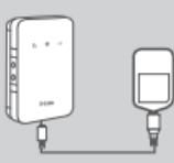
5. Collegare l'estremità Micro USB del cavo USB alla porta Micro USB situata nella parte inferiore del DWR-932 e collegare l'estremità USB nella porta USB dell'adattatore di alimentazione o di un computer per caricare la batteria. Quando la carica è completa, è possibile usare la porta USB per alimentare i dispositivi mobile.
