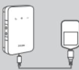
5. Kytke USB-kaapelin Micro USB -pää Micro USB -porttiin DWR-932:n pohjassa ja kytke USB-pää virtasovittimen tai tietokoneen USB-porttiin akun lataamiseksi. Kun lataaminen on suoritettu, voit käyttää tästä USB-porttia antamaan virtaa mobiililaitteisiisi.
