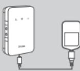
5. Tilslut Mikro USB-enden på USB-kablet ind i Mikro USB-porten nederst på DWR-932, og sæt USB-enden i USB-porten på strømadapteren eller en PC for at oplade batteriet. Når opladning er færdig, kan du bruge denne USB-port til at strømføre dine mobile enheder.
