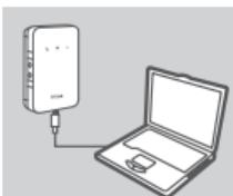
1. Připojte zařízení DWR-932 k počítači pomocí USB kabelu. Postupujte podle pokynů zobrazených v automaticky otevíraných oknech ovladačů Windows.
