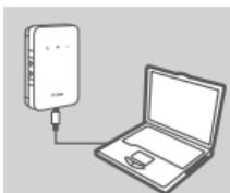
1. Collegare il dispositivo DWR-932 al PC utilizzando il cavo USB. Seguire le informazioni sul driver Windows che appaiono sullo schermo.
