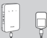
5. Připojte konec Micro USB kabelu USB k portu Micro USB na spodní straně zařízení DWR-932 a zapojte konec USB do portu USB napájecího adaptéru nebo počítače, čímž baterii dobijete. Jakmile se dobíjení dokončí, můžete tento port USB použít pro napájení mobilních zařízení.
