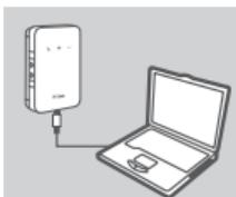
1. Podłącz router DWR-932 do komputera PC za pomocą kabla USB. Postępuj zgodnie z instrukcjami wyświetlonymi przez sterownik Windows.
