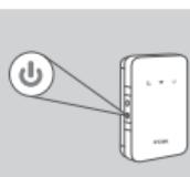
6. Trykk og hold inne av/på-knappen i fire sekunder for å slå på enheten. Når LED-lampen for av/på lyser uavbrutt grønt, kan du fortsette med konfigurasjonen.
