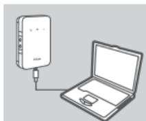
1. Sluit de DWR-932 aan op uw pc met behulp van de USB-kabel. Volg de instructies in de pop-upvensters van het Windows-besturingsprogramma.
