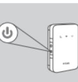
6. Tryk og hold på strømknappen i fire sekunder for at tænde for enheden. Når spændings-LED-ikonet lyser konstant grøn, kan du fortsætte med konfigurationen.
