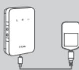
5. Pentru a încărca bateria, conectați capătul Micro USB al cablului Micro USB în portul de Micro USB din partea de jos a DWR-932 și introduceți capătul USB în portul USB al încărcătorului sau la un PC. După finalizarea încărcării, puteți utiliza acest port USB pentru a încărca dispozitivele mobile.
