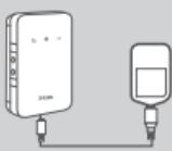
5. Ligue a extremidade Micro USB do cabo USB à porta Micro USB no fundo do DWR-932 e ligue a extremidade com a ficha USB na porta USB do adaptador de corrente ou a um PC para carregar a bateria. Depois do carregamento estar completo, pode utilizar esta porta USB para alimentar os seus dispositivos móveis.
