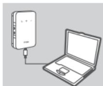
1. Συνδέστε το DWR-932 στον υπολογιστή σας χρησιμοποιώντας το καλώδιο USB. Ακολουθήστε τις οδηγίες που εμφανίζονται σε αναδυόμενα παράθυρα στην οθόνη από το πρόγραμμα οδήγησης των Windows.
