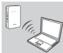
1. Χρησιμοποιήστε τον προσαρμογέα ασύρματης επικοινωνίας του υπολογιστή σας για να συνδεθείτε στο ασύρματο δίκτυο **dlink\_DWR-932\_xxxx**. Το όνομα του ασύρματου δικτύου (SSID) και ο κωδικός πρόσβασης αναγράφονται στην ετικέτα κάτω από την μπαταρία.
