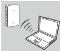
1. Verwenden Sie den drahtlosen Adapter Ihres PCs, um eine Verbindung zum Drahtlosnetzwerk **dlink\_DWR-932\_xxxx** herzustellen. Den Namen des Drahtlosnetzwerks (SSID) und das Kennwort finden Sie auf dem Aufkleber unter dem Akku.
