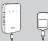
5. Sluit het uiteinde van de Micro USB van de USB-kabel aan op de Micro USB-poort aan de onderzijde van de DWR-932 en steek het USB-uiteinde in de USB-poort van de stroomadapter of een pc om de batterij op te laden. Na het opladen kunt u deze usb-poort gebruiken om uw mobiele apparaten op te laden.
