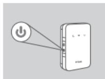
6. Pritisnite in štiri sekund držite gumb za vklop/izklop, da vklopite napravo. Ko ikona LED napajanja zasveti z zeleno, lahko nadaljujete s konfiguracijo.
