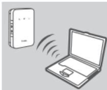
1. Utilize o adaptador sem fios do seu computador para ligar à rede sem fios **dlink\_DWR-932\_xxxx**. O nome da rede sem fios (SSID) e a palavra-passe estão impressos na etiqueta por baixo da bateria.
