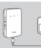
5. Συνδέστε το άκρο με βύσμα Micro USB του καλωδίου USB στη θύρα Micro USB στη κάτω μέρος του DWR-932 και το άκρο με βύσμα USB στη θύρα USB του τροφοδοτικού ή του υπολογιστή για να φορτίσετε την μπαταρία. Όταν ολοκληρωθεί η φόρτιση, μπορείτε να χρησιμοποιείτε αυτήν τη θύρα USB για να τροφοδοτείτε με ρεύμα τις φορητές συσκευές σας.
