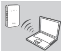
1. Utilizzare l'adattatore wireless del PC per collegarsi alla rete wireless **dlink\_DWR-932\_xxxx**. Il nome della rete wireless (SSID) e la password sono stampati sull'etichetta sotto la batteria.
