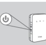
6. Pritisnite gumb napajanja i držite ga pritisnutim četiri sekunde kako biste uključili uređaj. Kada LED lampica ikone napajanja zasvijetli postojano zeleno možete nastaviti s konfiguracijom.
